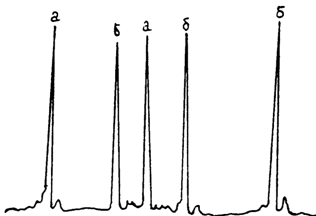
Рис. 2. Спектры анализа пиридина получены газ-жидкостным хроматографическим методом при распаде ГПК по реакции \text{ГПК} + [\text{CuПир}]^{2+} в начале (а) и в конце (б) реакции.
