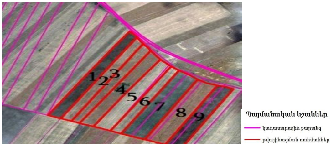
Նկար 3. Արբանյակային պատկերից հողամասերի սահմանների թվայնացում Arc GIS ծրագրային փաթեթի միջոցով
