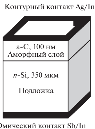
Рис. 1. Топология детектора на основе гетероструктуры а-С/ n -Si.
