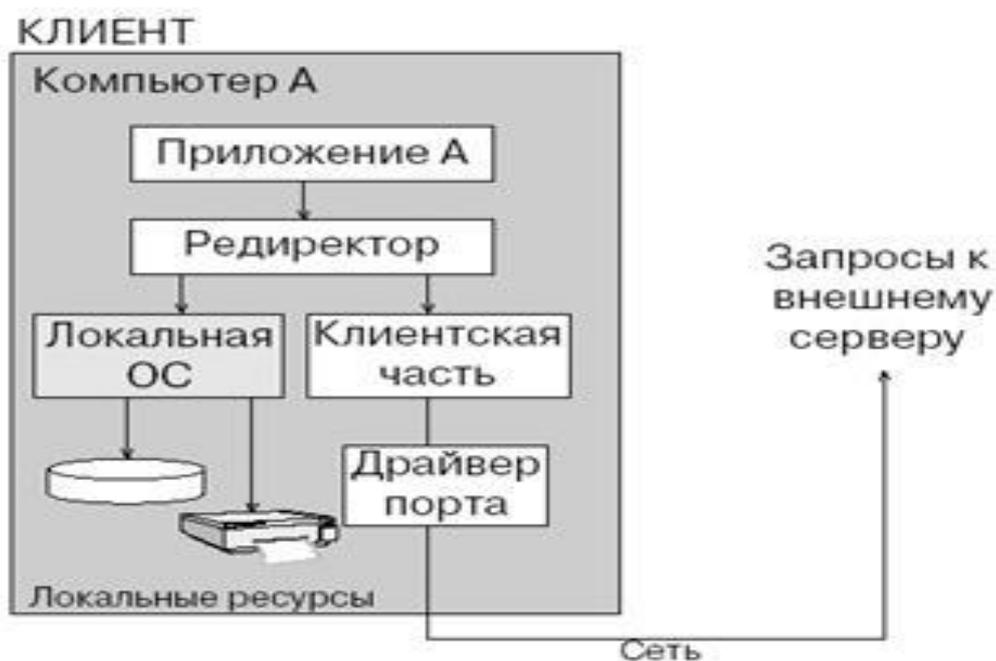
Рисунок 49. Компьютер в роли узла-клиента
